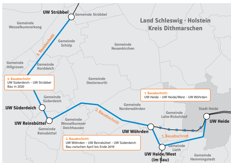
Bauabschnitte des 110-kV-Ersatzneubaus Heide - Heide/West - Strübbel
